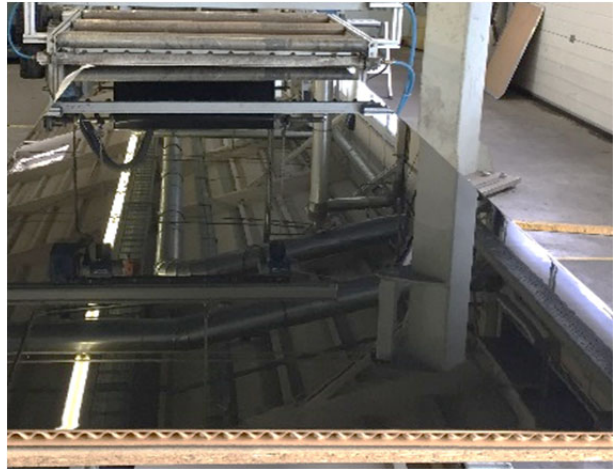
Beschichtung mit Rollenware auf einer Kalanderpresse
